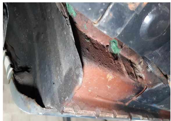
Traces de réparation provisoire sur bas de caisse arrière gauche
