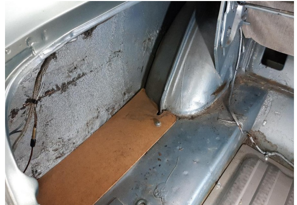
Trace de réparation sur la doublure d'aile arrière gauche
