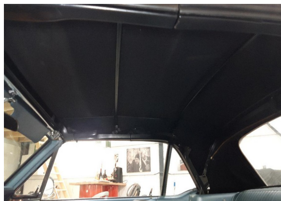
Ciel de toit
